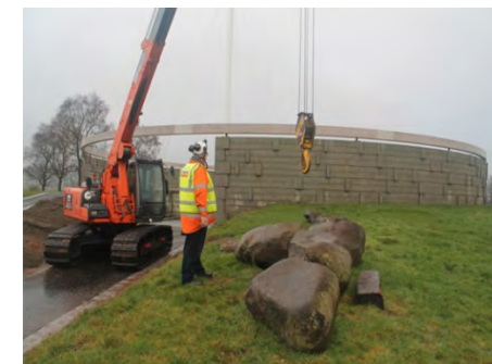
Рис. 6.21. Мини-гусеничный кран-робот MCC 804
