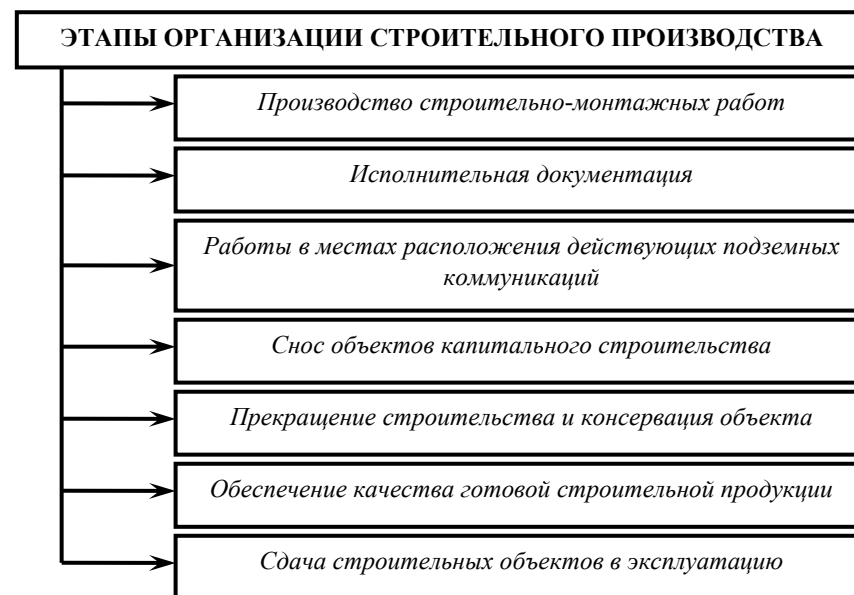
Рис. 1.5. Основные этапы организации строительного производства
