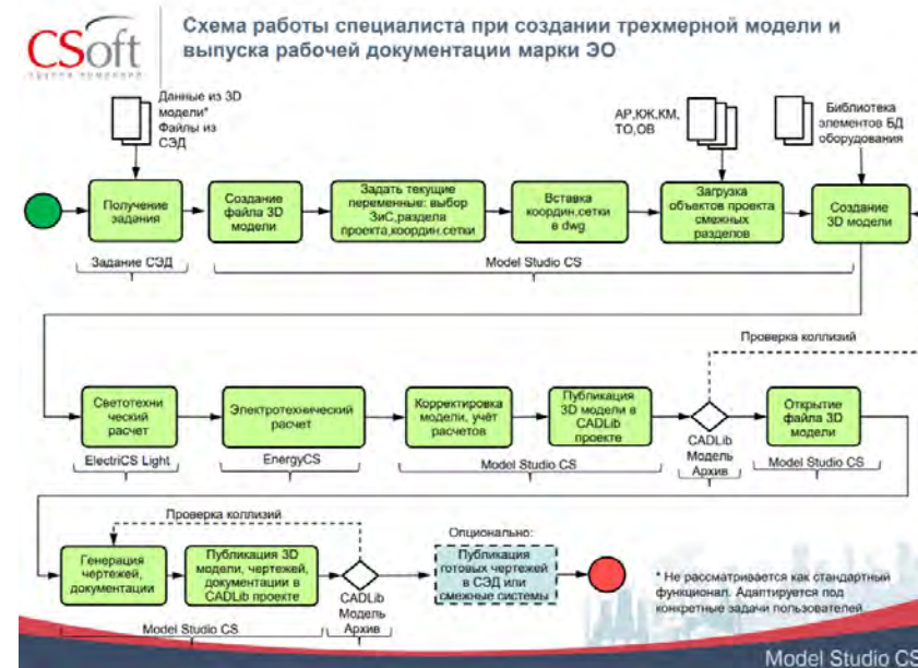
Рис. 4.5. Схема работы при создании 3D и выпуска РД марки ЭО ( https://www.mscad.ru/programs/electrical/ )
