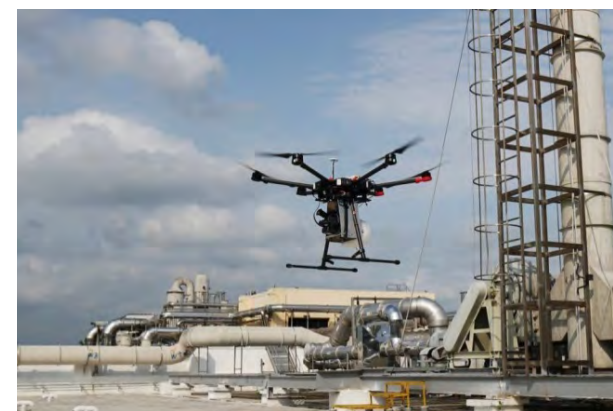
Рис. 6.14. Применение дронов для обследования теплосетей
