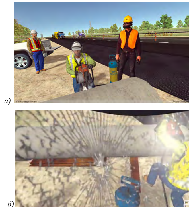
Рис. 6.33. Работа с Модулем Caterpillar Safety VR, Модуль показывает: а) как рабочий справа пилит трубу «болгаркой», осколок отлетает в голову ученика, б) какие будут последствия: разбитое стекло очков виртуальной реальности. Источник: CAT
