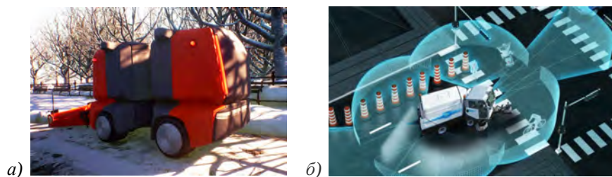
Рис. 6.53. Малый коммунальный робот компании «Автономика»: а) внешний вид робота-уборщика; б) схема работы робота-уборщика в соответствии с зоной расстановки датчиков
