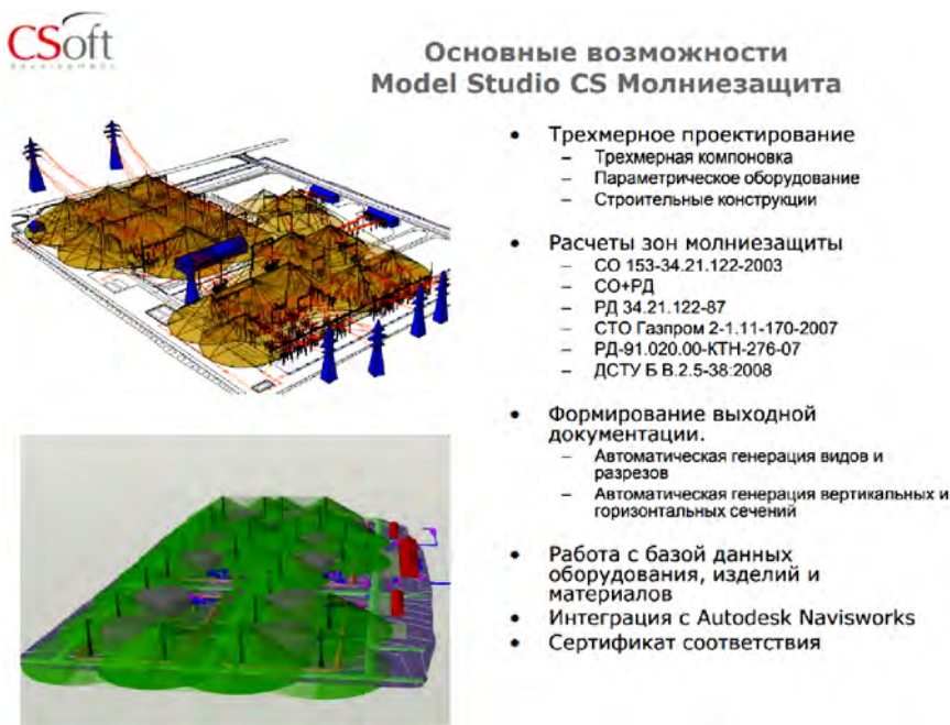
Рис. 4.10. Основные возможности Model Studio CS Молниезащита ( https://www.mscad.ru/programs/lightning-protection/ )
