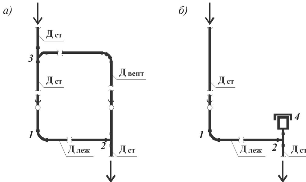
а) с устройством вентиляционного трубопровода (байпаса);
