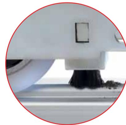
Система очистки каретки MACO HS; на каждой стороне каретки крепится щётка; на каждый элемент створки устанавливается по два ролика, в общей сложности – 4; щётки всегда функционируют в направлении перед роликом; 4 ходовых ролика, 4 щётки, всегда чистые при движении.
