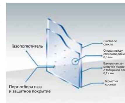
▲ Рис. 1. Структурная схема сверхтонкого вакуумного стеклопакета VIG
