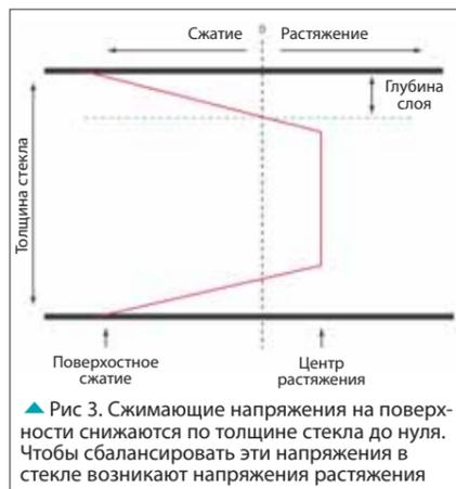
▲ Рис 3. Сжимающие напряжения на поверхности снижаются по толщине стекла до нуля. Чтобы сбалансировать эти напряжения в стекле возникают напряжения растяжения
