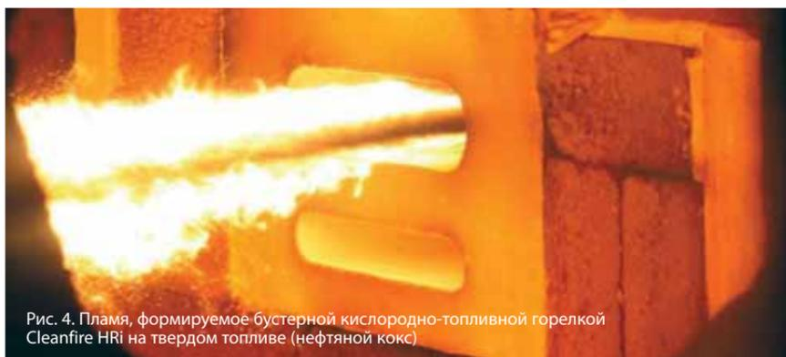
Рис. 4. Пламя, формируемое бустерной кислородно-топливной горелкой Cleanfire HRi на твердом топливе (нефтяной кокс)
