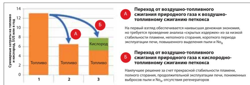
▲ Рис. 5. Суммарные затраты на топливо и кислород на регенеративной стекловаренной печи производительностью 300 т/сут до и после перевода на кислородно-топливную систему:
