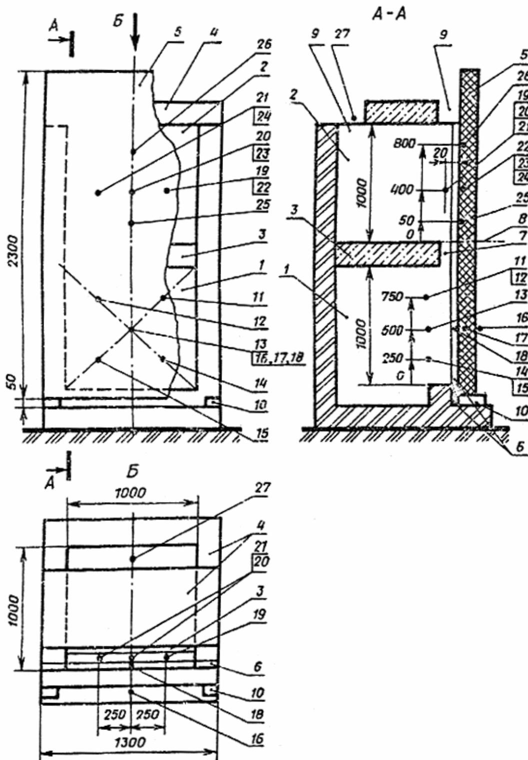
1 -огневая камера; 2 -тепловая камера; 3 -перекрытие, разделяющее огневую и тепловую камеры;
