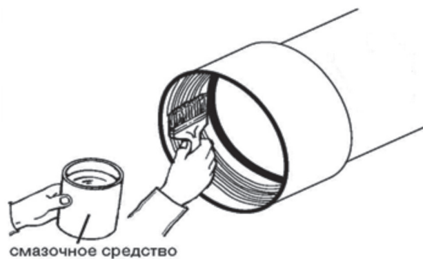
Рисунок Б.3 – Нанесение смазочного средства
