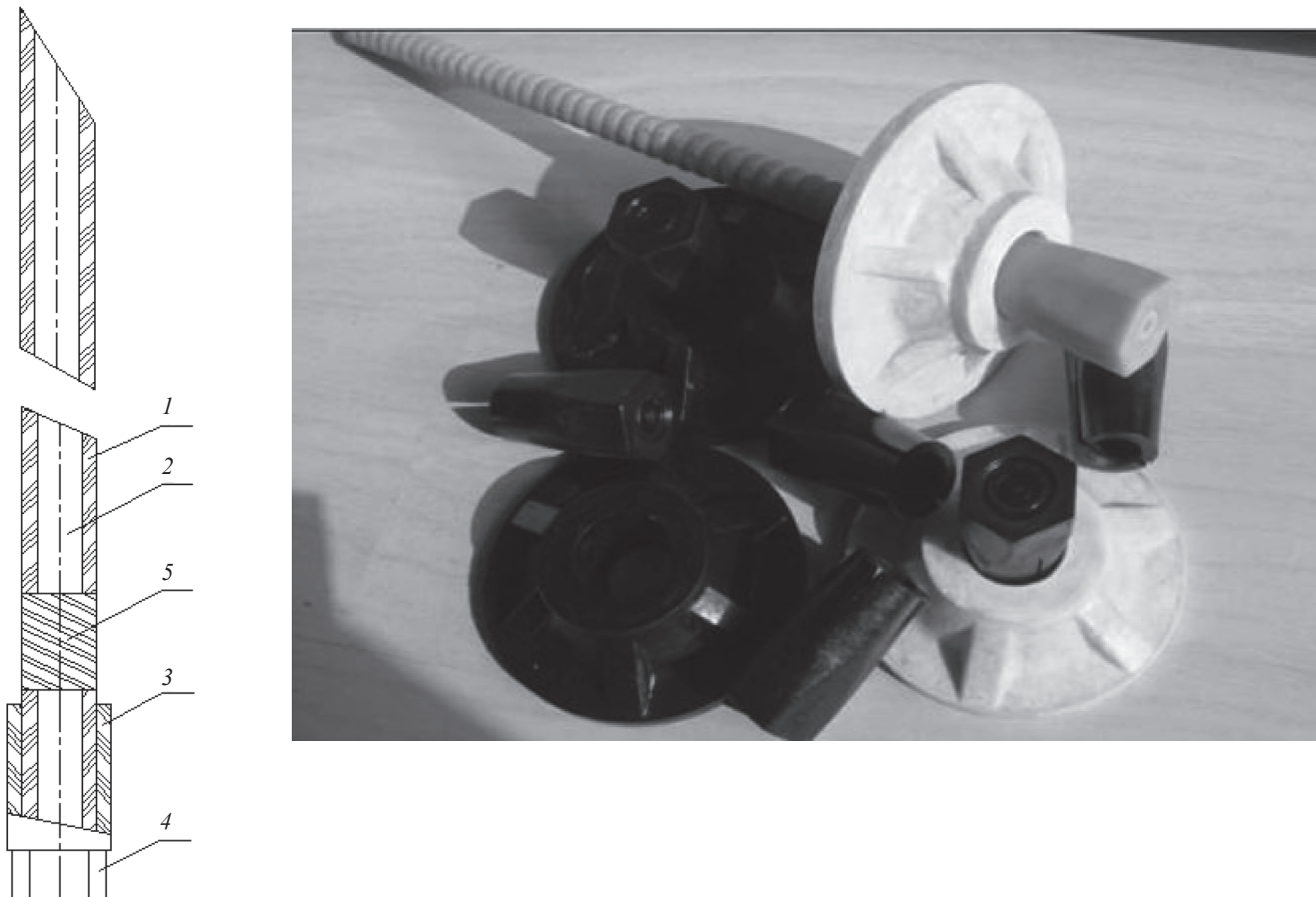
1 – стержень АНК-С трубчатого сечения; 2 – внутренний канал; 3 – втулка; 4 – торец нижний граненый; 5 – опорная пластина
